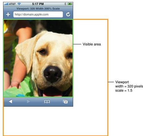
Figure 39 Le viewport de l'iOS configuré à une largeur de 320 pixels et une échelle de 150%
