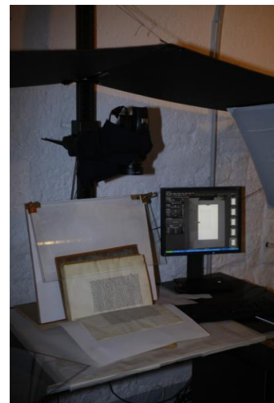
Figure 7: Poste de travail pour prise de vue avec dos numérique (source Azentis).
