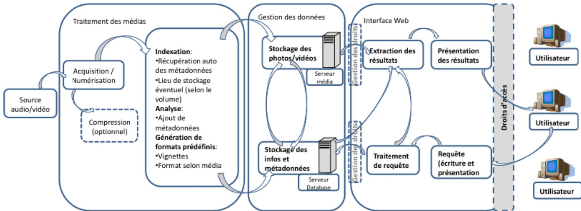
**Chaîne des fonctions et architecture d'un système de DAM, d'après [21], p. 74, figure 5.1**
