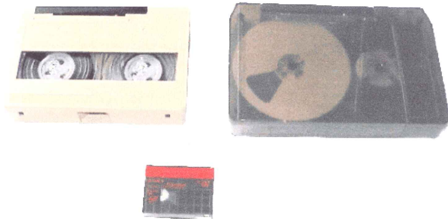
Comparaison de tailles entre deux cassettes U-matic en haut, et une cassette mini DV actuelle (en bas)
