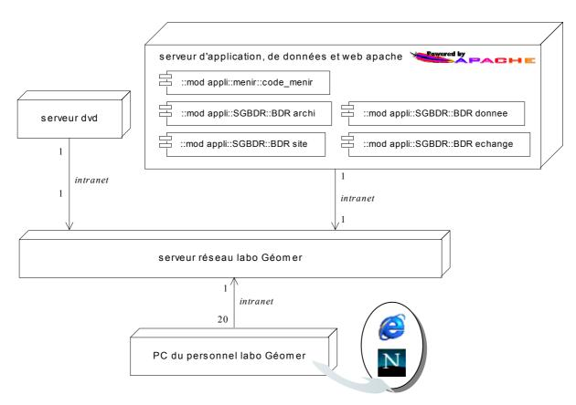
Figure 30 : Diagramme de déploiement de la maquette.
